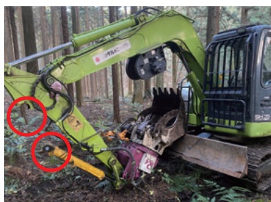
打撃・過負荷等によるシリンダー取り付け ブラケット破損
