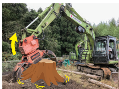
グラップルヘッドで の地ならし、伐根作 業による Tongue 凹み やシリンダー破損
