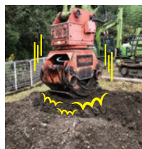
グラップルヘッドで の地ならし、伐根作 業による Tongue 凹み やシリンダー破損
