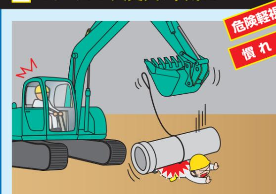
「1回だけだから」と油圧ショベルのバケットの「つめ」に玉掛けワイヤを掛けてヒューム管をつり降ろそうとして（用途外使用）、玉掛けワイヤが外れて作業者に激突した。
