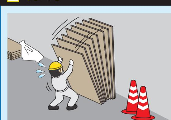
仮置きした型枠材が倒れそうになり、あわてて（パニック）とっさに重量のある型枠材を押さえようとして下敷きになった。
