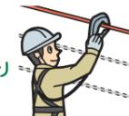
垂直構造物や斜材等に取り付ける場合、墜落制止時、ランヤードがずれたり、壊れたりしないようにする
