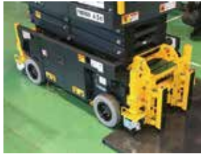
段差を検知すると動作を停止
