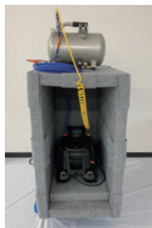
サイウォール(防音パネル)でコンプレッサーを囲うこともできます
