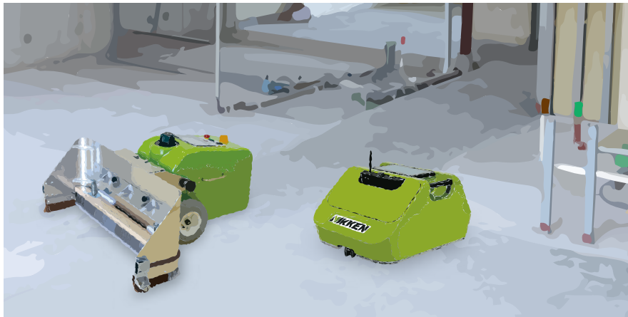
※自律型清掃ロボットとのコラボにより清掃→墨出しの自動化を実現!
