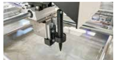
ペンプロッター方式を採用 本体の軽量化と描画の ランニングコストを削減
