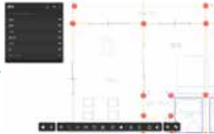
墨出しロボ用作業データ
