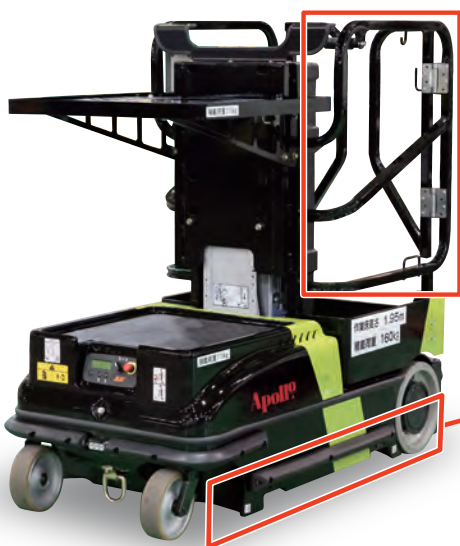
プラットフォーム ゲートアラーム装備
