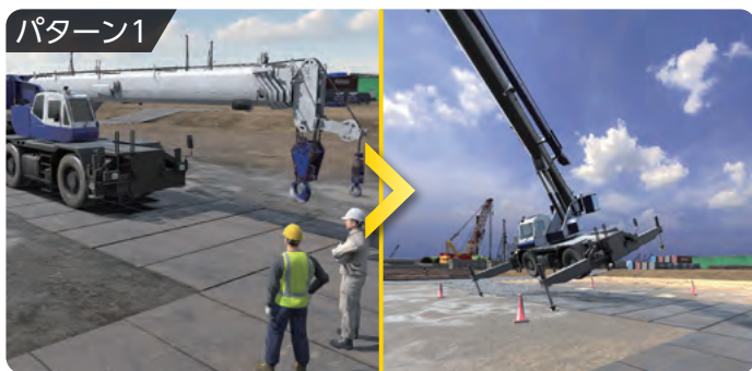
クレーンの危険体感(地盤不良)
