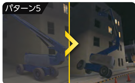
高所作業車の危険体感
