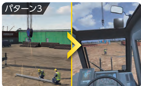
クレーンの危険体感(玉掛け不良)
