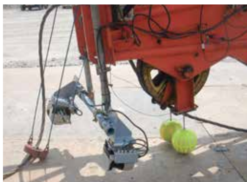
クレーン先端への 設置例(有線式)
