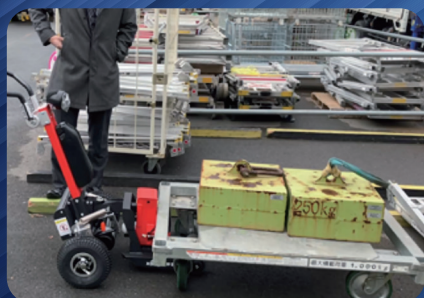
パイプ台車を連結して使用
