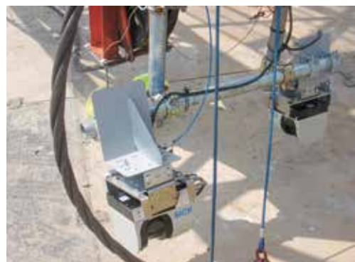
クレーン先端への 設置例(有線式)
