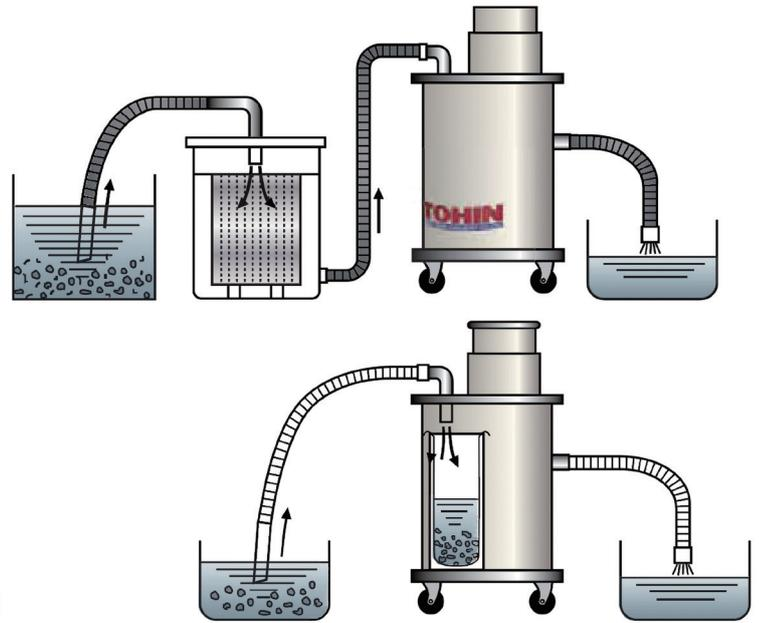
本機マイクロスーパークリーナーは従来のバキュームクリーナーと異なり、単にものを吸引するだけの機能から固形物の混合した水・オイルなどの各種液体を吸引し、本機独自の分離機構によって固形物を分離回収することができます。またタンク内に回収された液体は本機付属のポンプ機能によって強制的に排出し、他所へ吸引と同時に移送することもできます。
