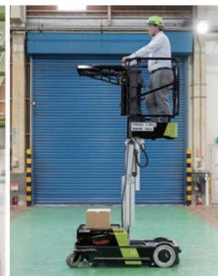
■ 作業の様子 (作業床は1.95m上昇)
