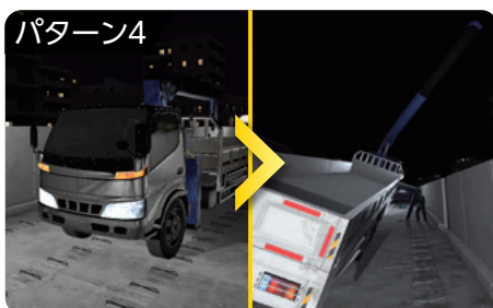
トラッククレーンの危険体感
