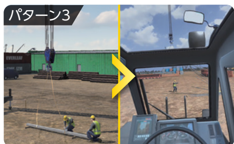
クレーンの危険体感(玉掛け不良)
