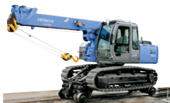
鉄道用クローラ クレーン8.0t吊
